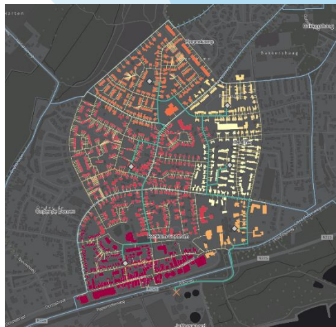
Figuur 3 Schetsontwerp warmtenet SKP in Renkum. Dit ontwerp is gebruikt om een indicatie van de leidinglengtes en diameters te bepalen en dient niet als voorontwerp. De SKP bron is als kruis aangegeven.
